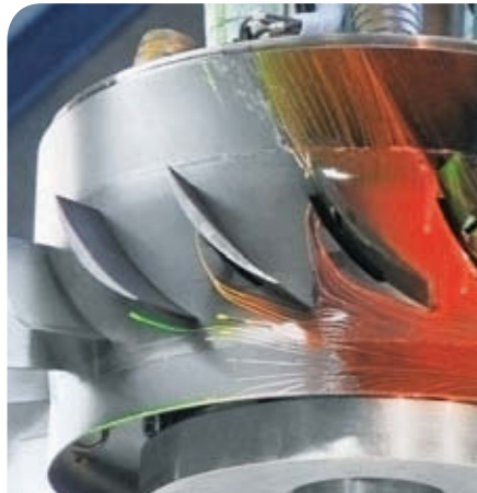
Blade profile aspiration being tested at EPFL (École Polytechnique Fédérale de Lausanne).
